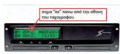
Εικόνα 2. Ταχογράφος που πρέπει να είναι τοποθετημένος σε φορτία που μεταφέρουν επικινδύνα υλικά.
